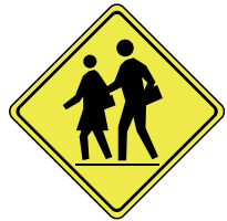
Signal avancé d'un passage pour écoliers
