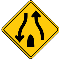
Fin des chaussées séparées
