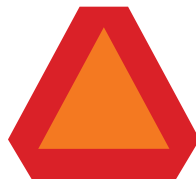
Véhicule lent Monté à l'arrière de véhicules circulant à moins de 40-km/h Avertit les conducteurs qui approchent de ralentir
