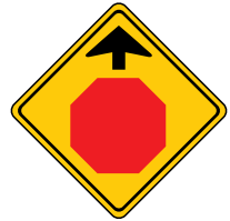
Signal avancé d'arrêt
