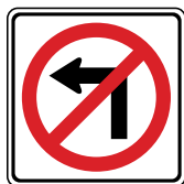
Virage à gauche interdit
